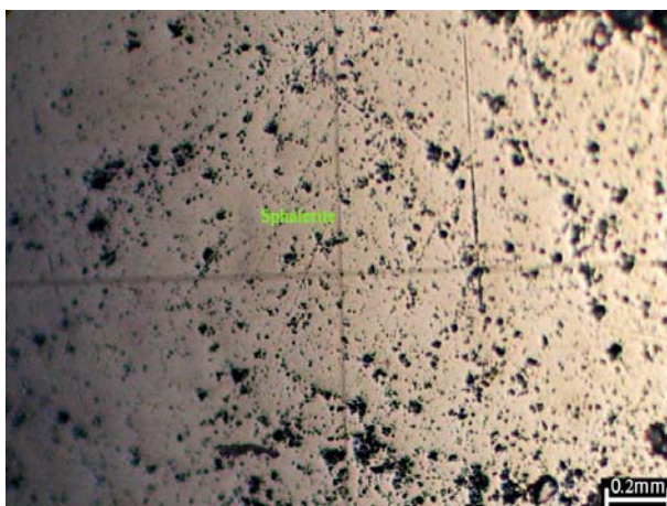
تصویر پ -۳-۵: توده بزرگی از کانی اسفالریت و با بافت یکنواخت که در این جا نیز به طور عمده سالم مانده است.
