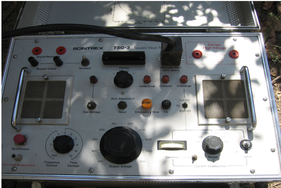
شکل ب - دستگاه ترانسیمتر TSQ-3
