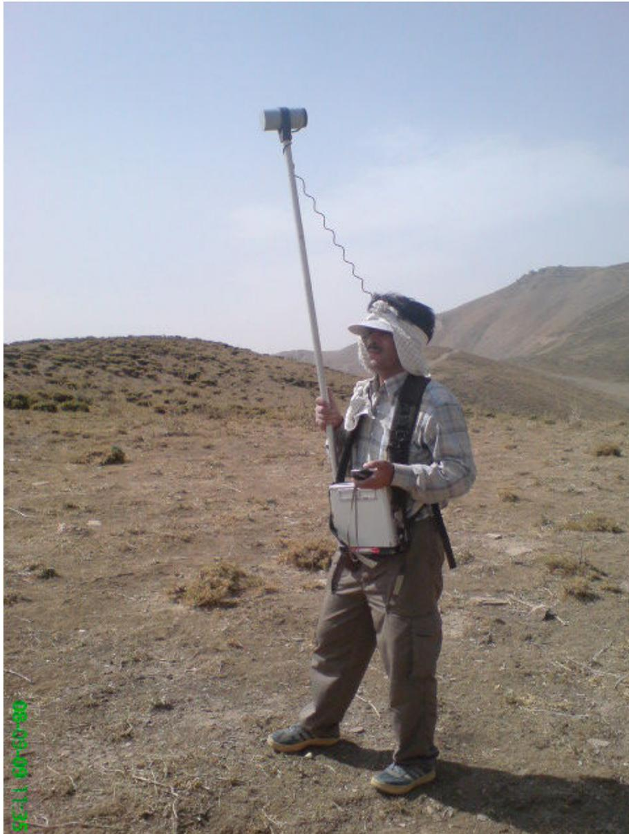
تصویر شماره ۳ - عملیات اندازه گیری مغناطیس با استفاده از مغناطیس سنج MP3
