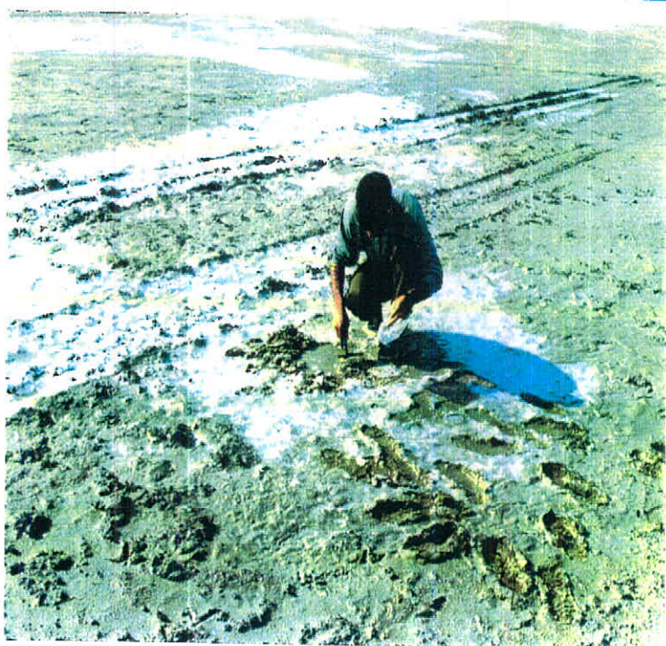
شکل ۳-۶۱: نمونه برداری از نمک های در حال تشکیل و آب دریاچه از عمق ۵۰ سانتی متری ایستگاه C۵
