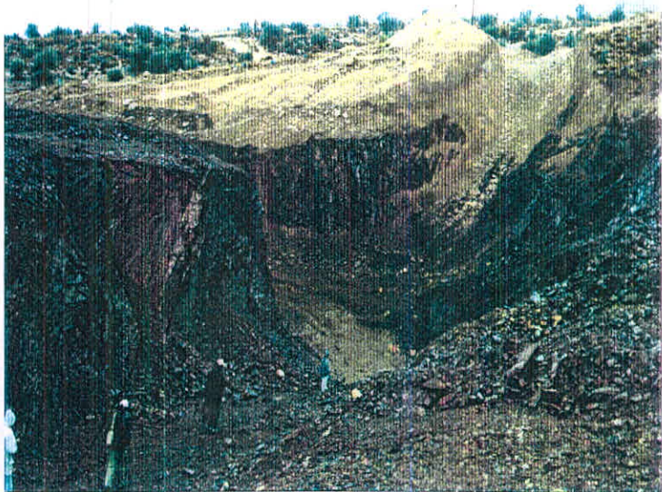
شکل ۳-۱۱: ترانشه اصلی موجود در ایستگاه A۴ و لایه های منگنز دار آن
