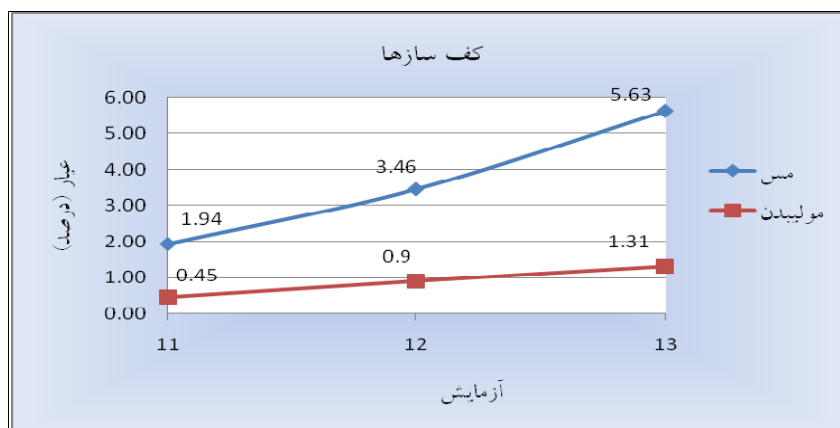
شکل ۳-۱۳: نمایش عملکرد کف‌سازها بر عیار مس و مولیبدن
