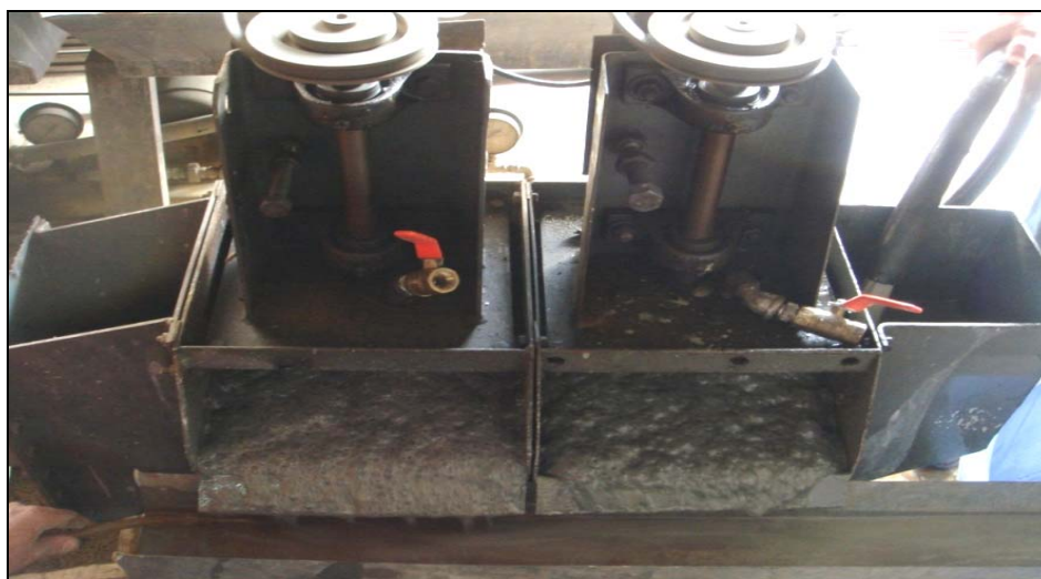
شکل ۳-۱۸: فلوتاسیون مرحله رافر آزمایش ۲۰ کیلوگرمی همراه با بار در گردش
