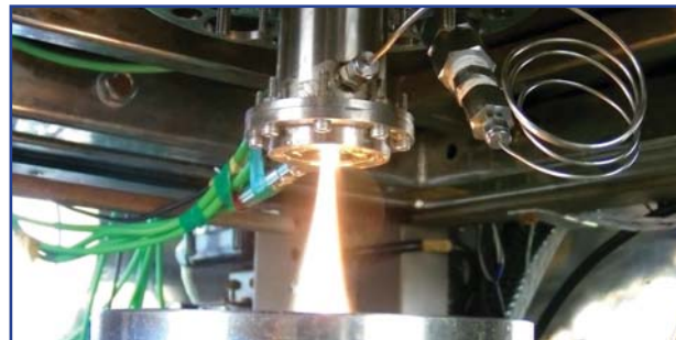
تست گرم نمونه آزمایشگاهی تراستر دو پیشرانه
