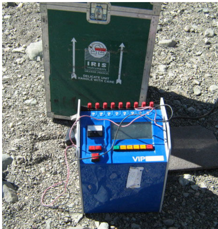
تصویر شماره ۱۲- ترانسمیتر VIP ساخت شرکت IRIS فرانسه
