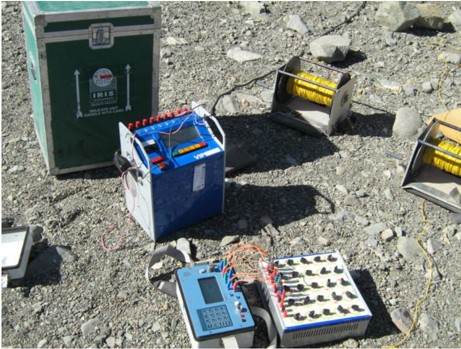
تصویر شماره ۱۱- مجموعه رسیور و ترانسمیتر به همراه سویچ باکس و سیمهای فرستنده جریان
