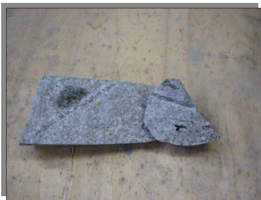
تصویر شماره ۵-۳- مغزه‌های حفاری مربوط به کانی‌سازی مس در کیکال در نمونه بالایی بافت پورفیری سنگ میزبان و در نمونه زیرین کانی‌سازی کالکوپیریت و رگچه کوارتز جلب توجه می‌کند.
