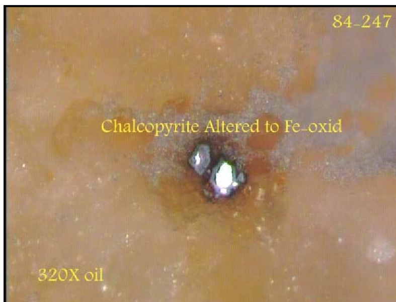
عکس ۲-۴ - تجزیه کالکوپیریت به اکسیدهای آهن
