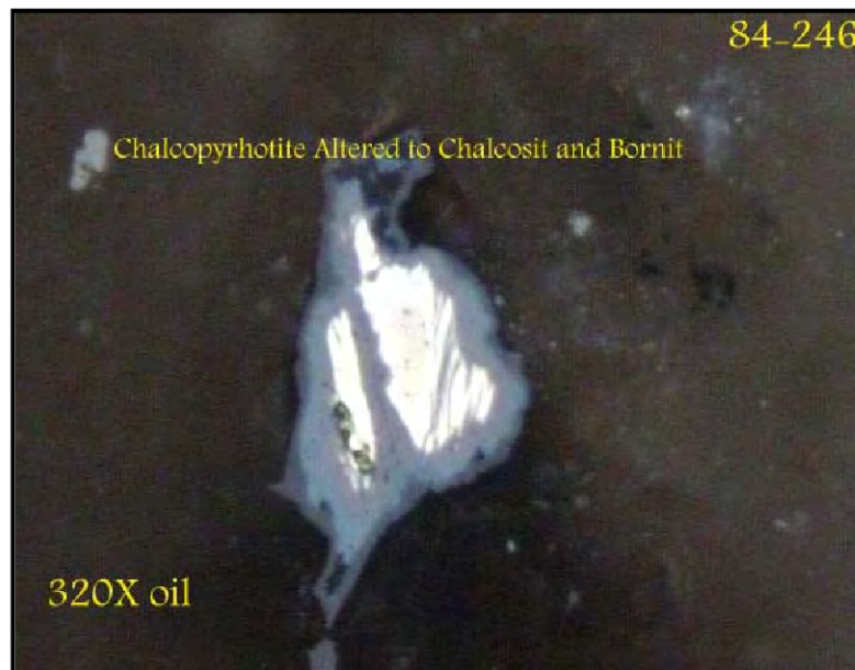
عکس ۴-۵- آلتراسیون کالکوپیروتیت به کالکوسیت و بورنیت
