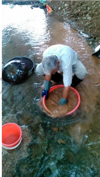
تصویر ۱-۷- نمایی از لاوک شویی از کانی سنگین در محدوده
