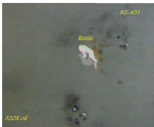
شکل 4-13- تصویر میکروسکوپی کانی روتیل در مقطع صیقلی
