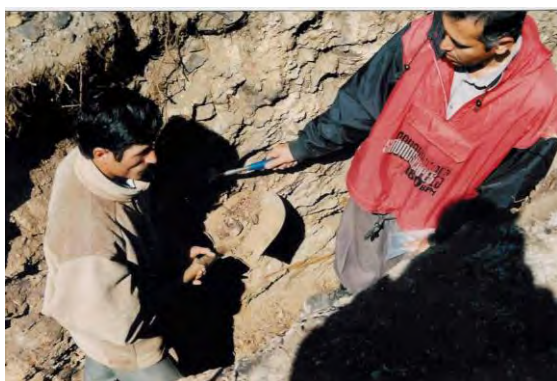
شکل 3-5- نمونه‌گیری شیاری از دیواره ترانسه 2
