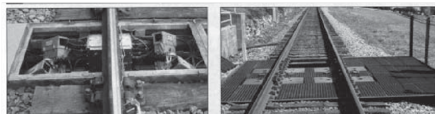
شکل ۳-۱- سیستم تشخیص بریدگی و تیزی چرخ
