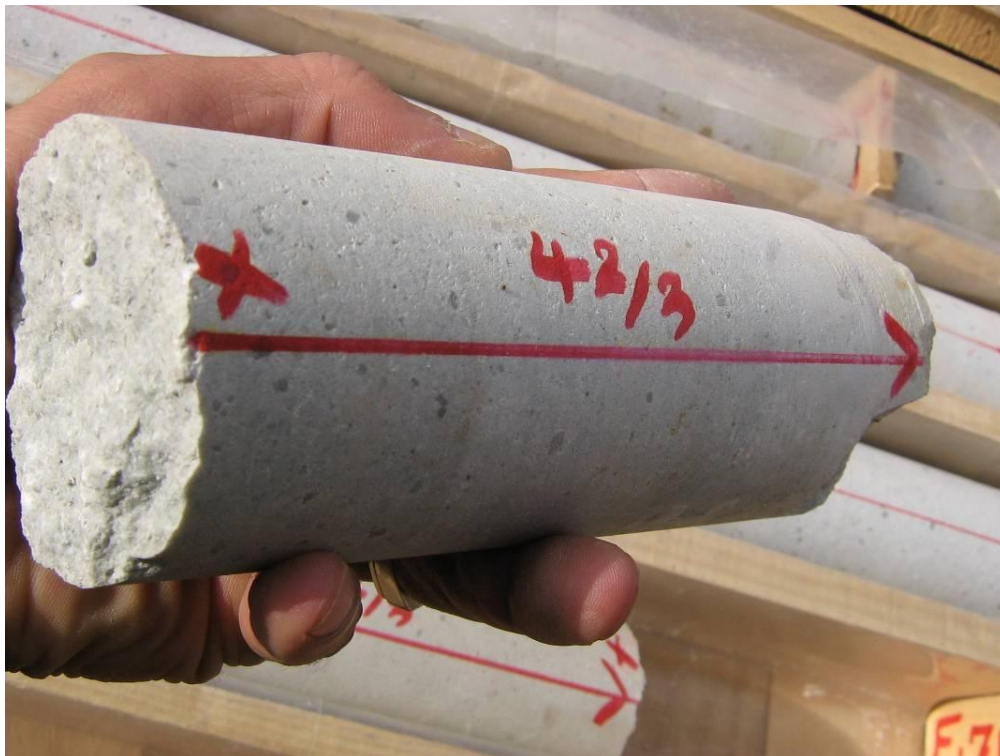
عکس شماره ۳-۶- ثبت شماره RUN و قطعه بالای 10cm (علامت * نشان دهنده شکستگی مکانیکی است).
