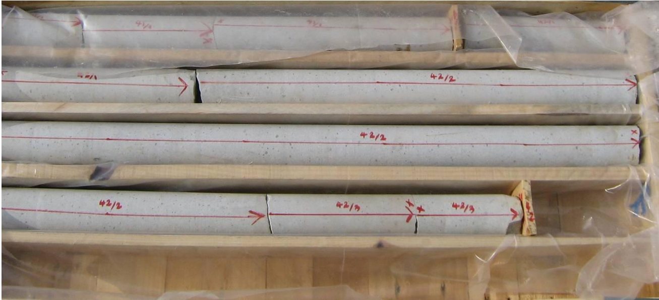
عکس شماره ۲-۶- نحوه چینش مغزه‌ها در جعبه و فلش گذاری جهت حفاری .
