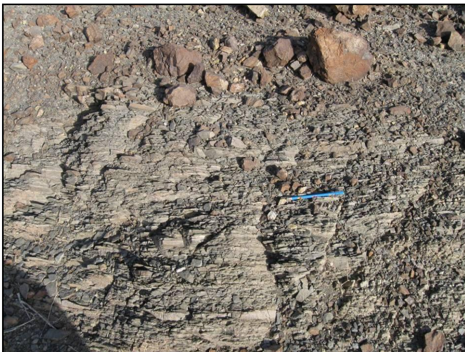
شکل ۲-۸۷- شکستگیهای موازی هم توسعه یافته در پهنه گسل (fault cleavage) (موقعیت:
