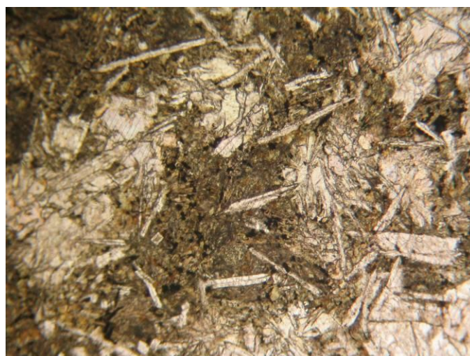
شکل ۶۲-۲- زمینه دانه ریز آکتینولیتی شده و بافت پورفیری، نور LN، بزرگنمایی 4X، مقطع شماره 10027، واحد J_2^d (موقعیت نمونه: X=545834, Y=3139349)
