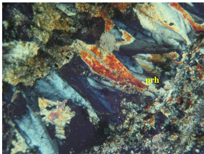
شکل ۲-۴۲- پرهنیت، نور LP، بزرگنمایی 4X، مقطع شماره 100022، واحد J_2^{V.m} (موقعیت نمونه: X=545088, Y=3139142)
