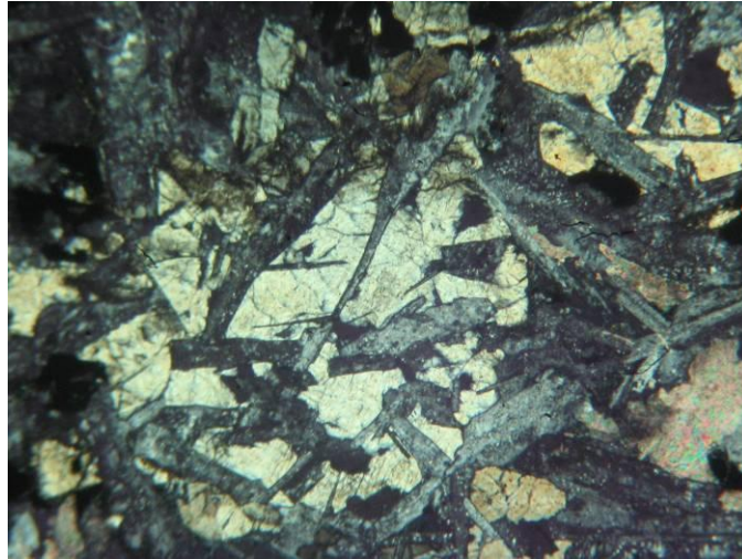
شکل ۲-۴۰- بافت افیتیکی، نور LP، بزرگنمایی 4X، مقطع شماره 10004، واحد J_2^{V.m} (موقعیت نمونه: X=545047, Y=3139308)
