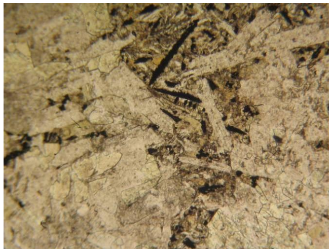
شکل ۲-۴۱- دو نوع بلور، درشت دانه اولیه و ریز دانه زمینه، نور LN، بزرگنمایی 4X، مقطع شماره 10008، واحد J_2^{V.m} (موقعیت نمونه: X=545171, Y=3139089)
