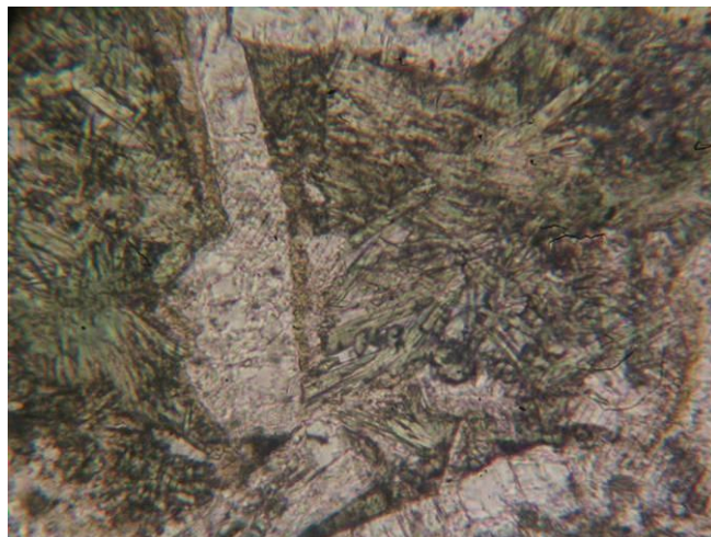
شکل ۶۱-۲- بلورهای سوزنی آکتینولیت که بخرج cpx بوجود آمده است، نور LN، بزرگنمایی 25X، مقطع شماره 10019، واحد J_2^d (موقعیت نمونه: X=545836, Y=3139332)
