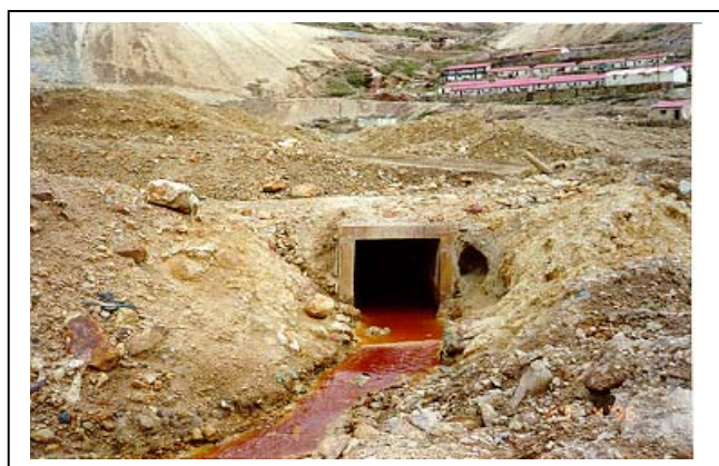
شکل ۳-۲-۲-۱ تغییر رنگ رودخانه بدلیل نهشت هیدروکسید آهن ناشی از زهکشی اسیدی معادن سولفیدی [66]
