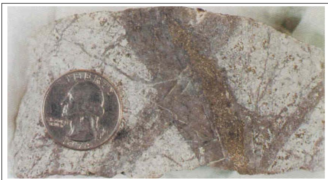
شکل ۱-۱-۲-۲ رگچه های متقاطع از کوارتز، پیریت و کالکوپیریت در کانسار مس پورفیری گرانسیل (Granisle) در بریتیش کلمبیا [61].
