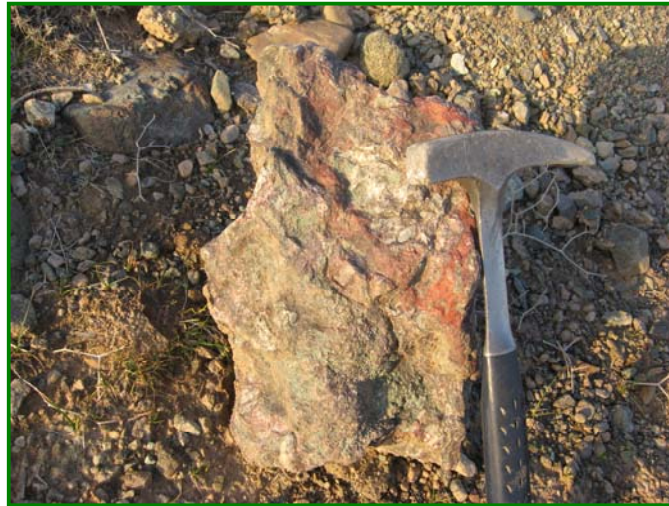
شکل ۲-۱۲: قطعات ژاسپروئیدی قرمز رنگ ، سیلیس‌هایی با بافت گل کلمی و ایگنمبریت
