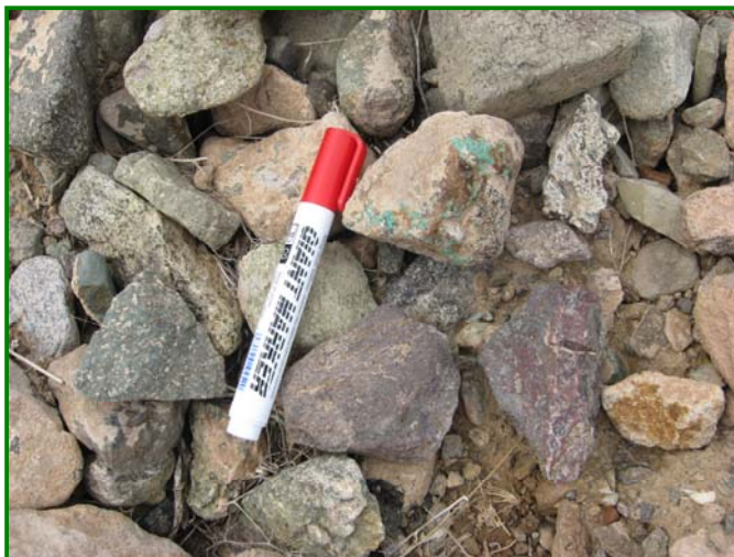
شکل ۲-۱۴: آغستگی سنگ‌های نابرجا (فلوت) به ملاکیت در بخش‌های باختری محدوده مورد مطالعه
