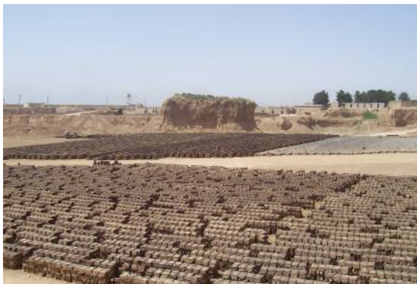
تصویر ۷- نمایی از مرحله خشک شدن خشت پس از قالب زدن
