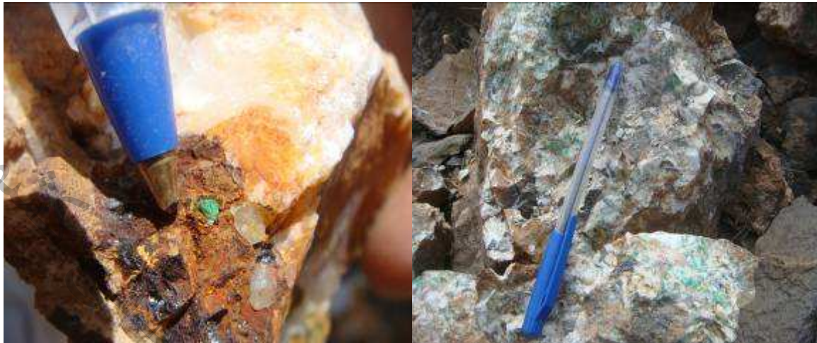
تصویر ۴-۲- کانی مالاکیت به صورت بلوری در داخل رگه سیلیسی همراه با اکسیدهای آهن
