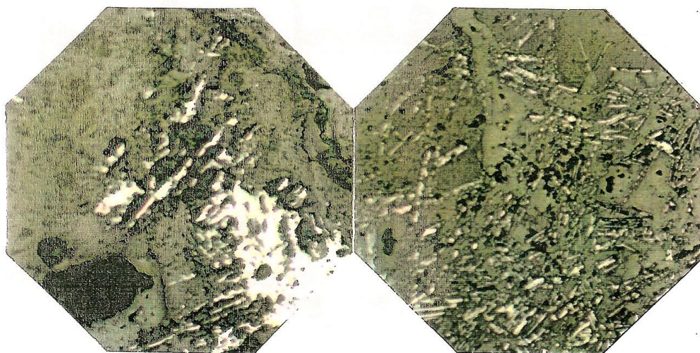
تصویر ۴-۱۸- کانه های هماتیت با اگرکات رشته ای و شعاعی در مقطع صیقلی شماره KH-OM-06 بزرگنمایی X200
