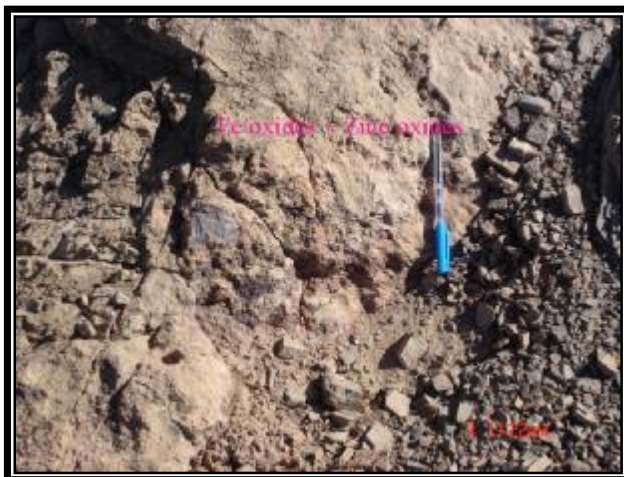
شکل 26- نمای نزدیک از حفرة h 11 و آثار اکسیدهای روی (سفیدرنگ) که در درزه و شکستگیهای آن مشاهده می‌شود. دید به سمت
