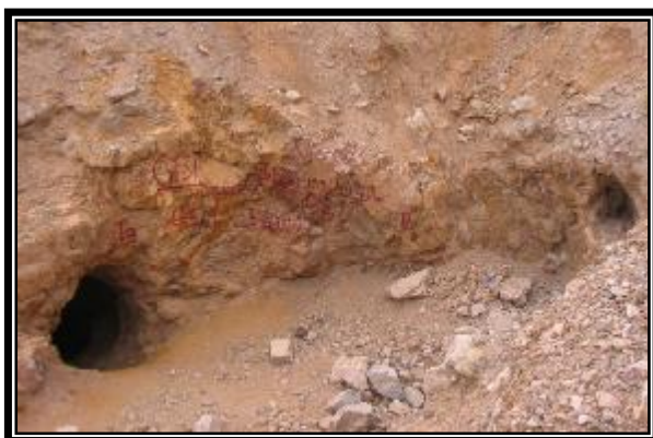
شکل 34- نمای نزدیک از تونل T 3 و محل حفر آن که تقریباً در افق ماده معدنی حفر شده است.
