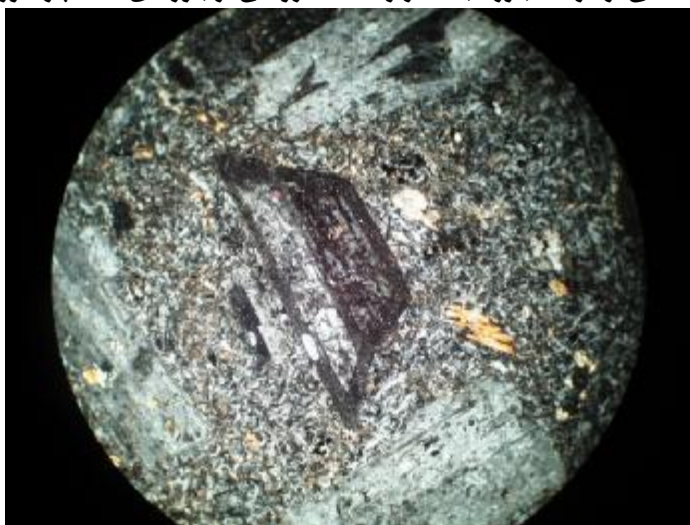
تصویر شماره 4-58: نمایی از درشت بلورهای آلبیت در زمینه میکروولیتی از بلورهای فلدسپار. آلبیتها از حاشیه سرسیتی شده اند (نورپلاریزه متقاطع، 4x).
