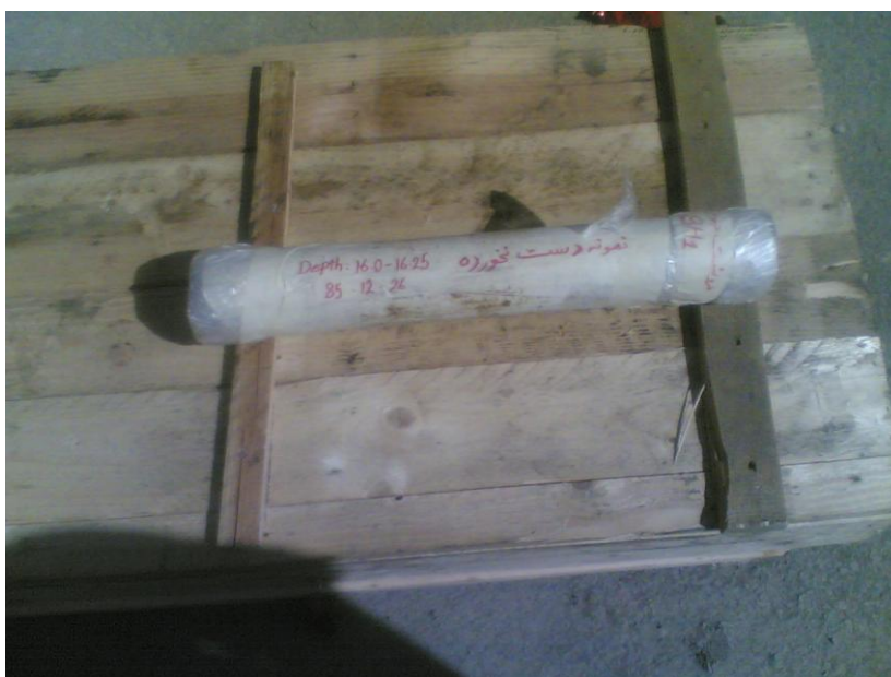
شکل ۱۰- نمونه‌گیر شلیبی (Shelby Sampler)
