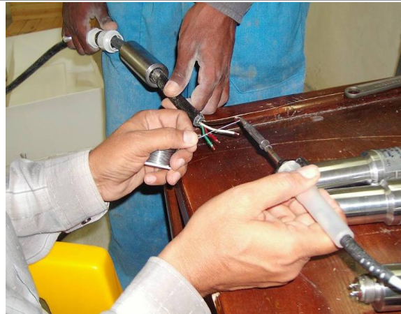
شکل ۱-۱۱- آماده سازی پیزومتر (اتصال کابل به سنسور، لحیم کاری)
