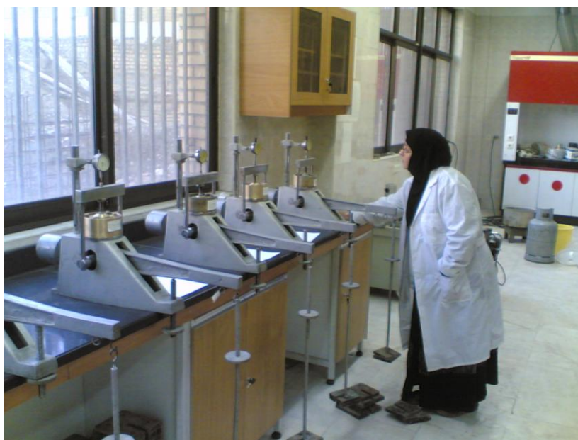
شکل ۲۴- نحوه انجام آزمایش تحکیم
