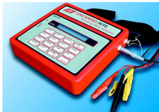
شکل ۱-۱۳- دستگاه واحد قرائت (Readout Unit) جهت قرائت ابزار تار مرتعش
