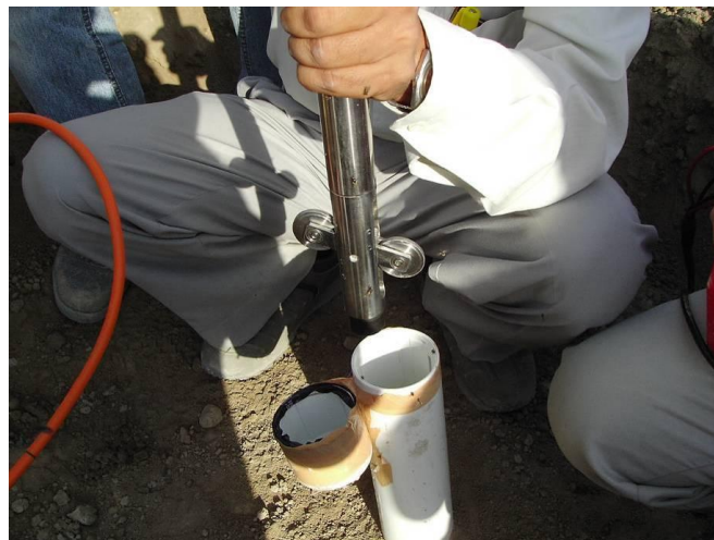
شکل ۱-۱۵- وارد کردن پروب انحراف‌سنج (Torpedo) در رابط (کوپلینگ) کیسینگ‌ها جهت اندازه‌گیری حرکات جانبی
