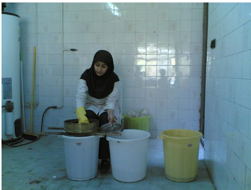
شکل ۲۰- شستشوی نمونه در آزمایش دانه بندی
