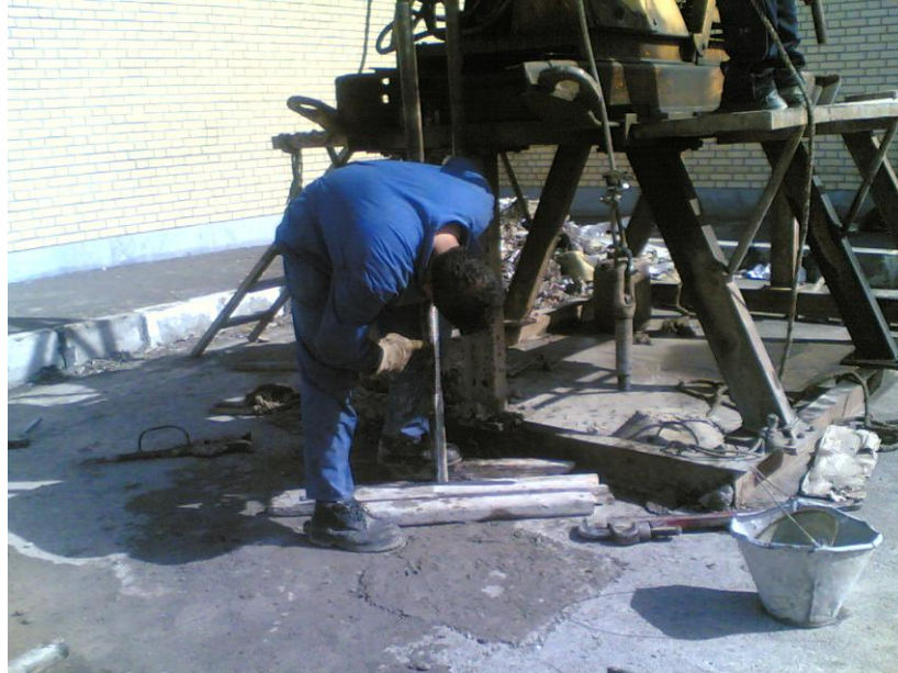
شکل ۳- انجام آزمایش نفوذ استاندارد، SPT
