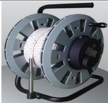
شکل ۱-۱۸- دستگاه سونداژ مدل EDS-91/2.1 جهت اندازه گیری تراز نشست سنج‌های مغناطیسی نشست (Magnetic Settlement Gage)
