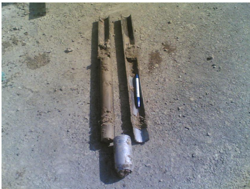
شکل ۵- نمونه گیر دوکفه‌ای آزمایش نفوذ، SPT (Split Spoon Sampler)
