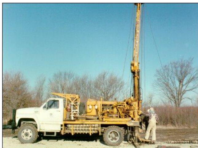
شکل ۱-۶- دستگاه حفاری دورانی سوار بر کامیون
