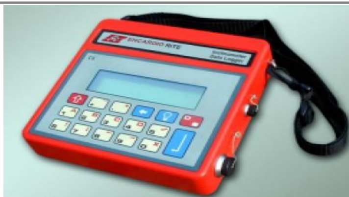
شکل ۱-۱۶- دستگاه داده نگار (Data logger) انحراف سنج
