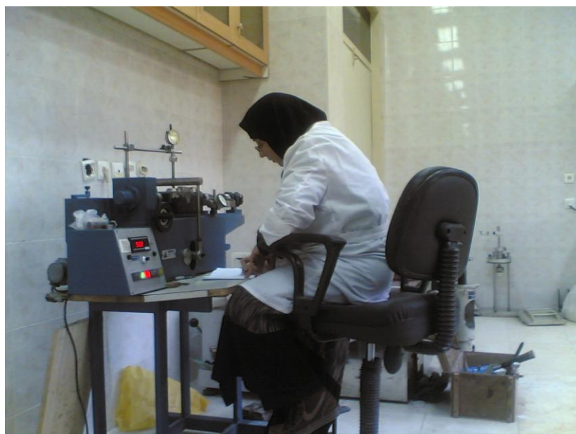
شکل ۲۳- نحوه انجام آزمایش برش مستقیم
