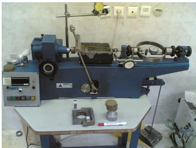
شکل ۲۲- دستگاه آزمایش برش مستقیم و نمونه خارج شده از آن
