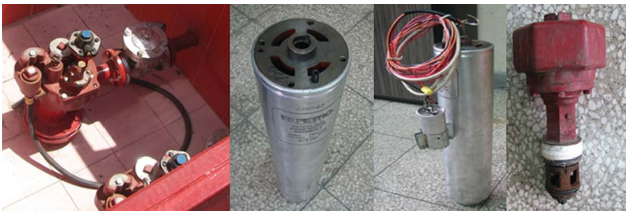
پمپ غریق و اجزاء مختلف آن
