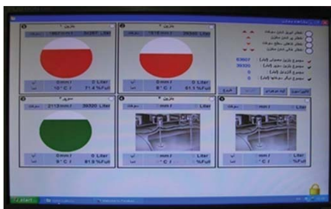
نمایش اطلاعات ارسالی از تجهیزات LG/TG بر روی مانیتور دفتر جایگاه
