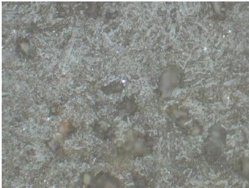
عکس 5-15- ذره مشکوک به طلا در مرکز عکس X100 در مقطع شماره 70 (بدون نیکل)
