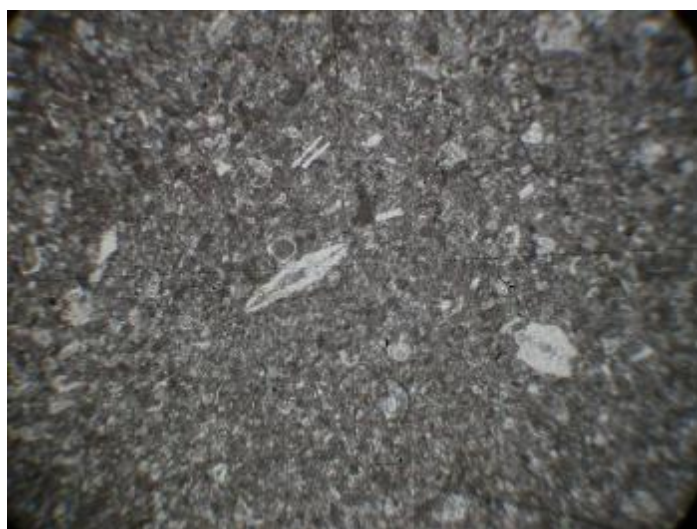
عکس 3-33- نمای کلی از مقطع RD23 در نور طبیعی با بزرگ‌نمایی (X5) که قطعات آلوکم فسیلی فراوانی در آن دیده می‌شود.
