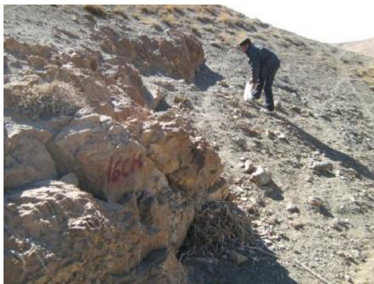
عکس 5-2- محل برداشت نمونه 16ch از محل کنتاكت واحد آذرین خروجی با سنگ‌آهك
