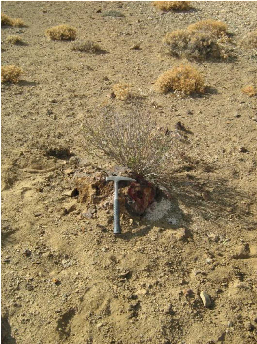
عکس 5-5- محل برداشت نمونه 53ch که محل رگه بسیار کوچکی از جنس سنگ آهک قهوه‌ای - قرمز رنگ (محل قرارگیری چکش) در کنتاکت با واحد آذرین خروجی بوده که میزان آهن و منگنز در این نقطه بالاترین مقدار محدوده را داشته است.
