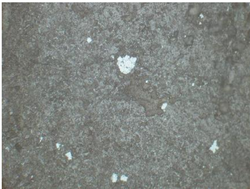
عکس 5-12- لکه های ریز و درشت پر شده از اکسید هیدروکسیدهای آهن X400 در مقطع شماره 50 (بدون نیکل)
