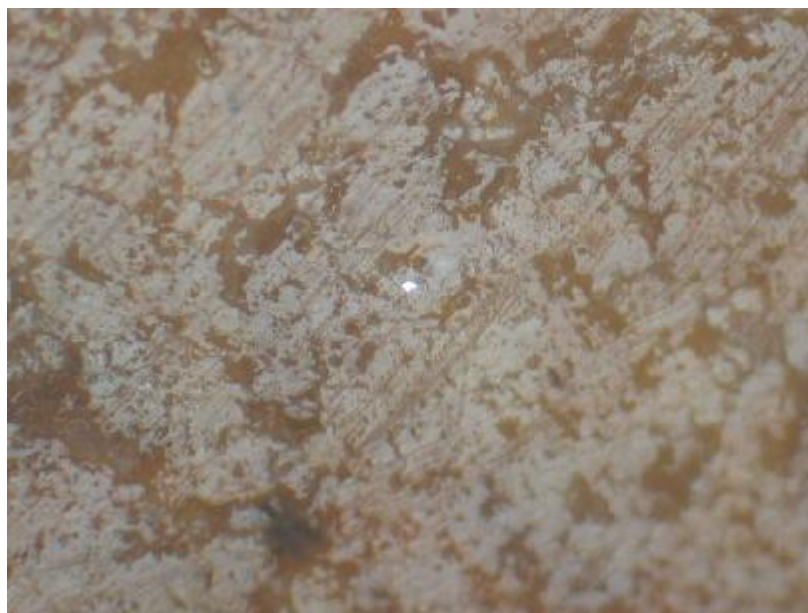
عکس 5-11- ذره مشکوک به طلا در مرکز عکس X650 در مقطع شماره 40 (بدون نیکل)
