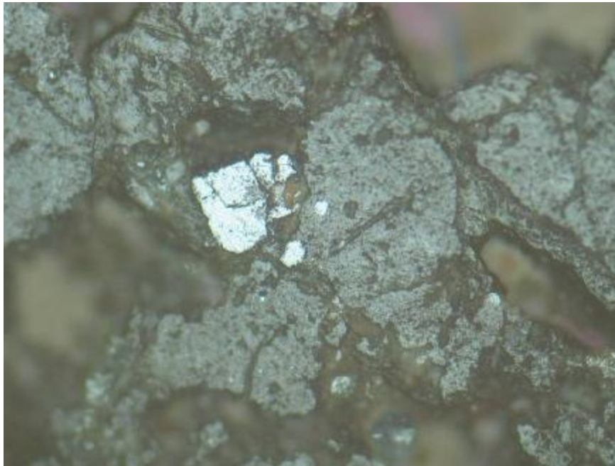
عکس 5-21- بلور منیتیت در سنگ X500 در مقطع شماره 120 (بدون نیکل)
