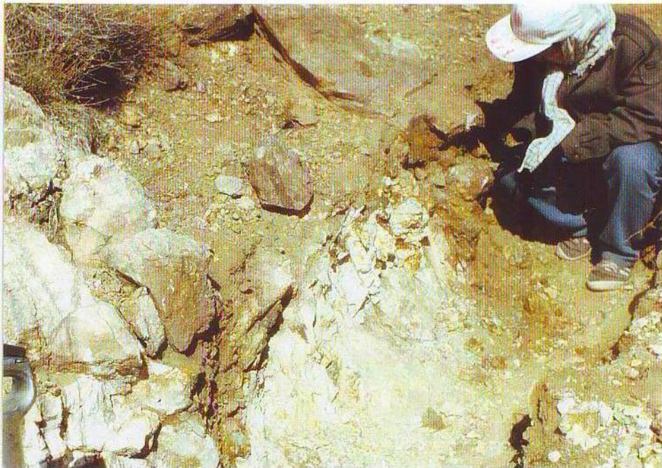
عکس شماره ۲-۴: همبندی لایه‌های کلسیتی (سمت چپ - رنگ سفید) با لایه‌های سیلیسی (کرم رنگ - سمت راست). لایه‌های لیمونیتی - سیلیسی شده دارای کانی سازی طلا است در صورتیکه لایه‌های کلسیتی فاقد کانی سازی هستند.
