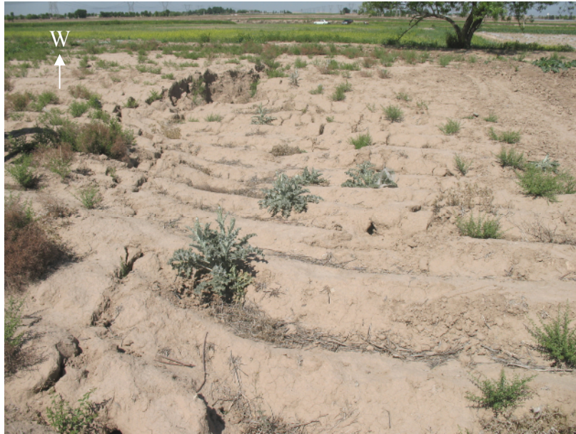
تصویر شماره ۴- اولین گودال بزرگ ناشی از شکاف سری A در بخش خاوری آن (نقطه A۱)
