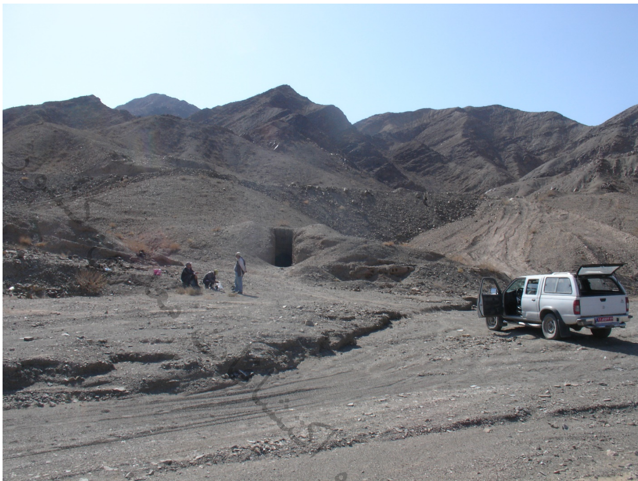
شکل ۳-۳- تونل استخراجی سرب و روی در سنگ میزبان شیل و ماسه سنگ در کنتاکت توده ساب و لکانیکی میکرو دپوریت (دید به سوی جنوب شرق)
