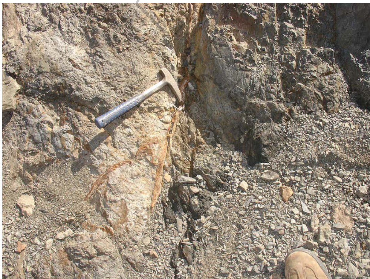
شکل ۳-۲۶- نمایی از رگچه های لیمونیتی- هماتیته به میزبانی ولکانیک های آلتزه
