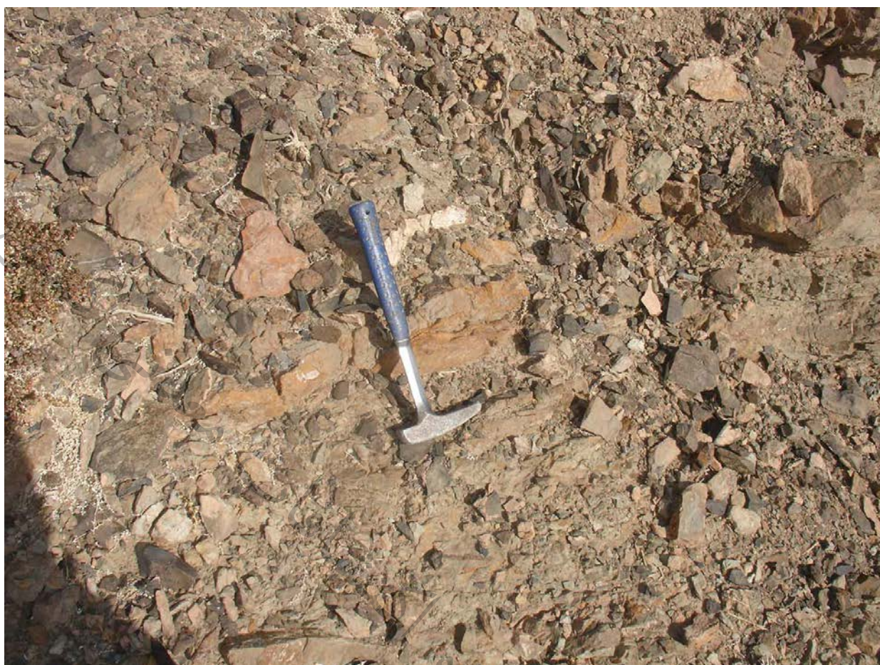
شکل ۳-۳۳- رگه کربناته- سیلیسی زرد رنگ لیمونیتی به ضخامت حدود ۲ الی ۵ سانتیمتر به میزبانی واحد شیل و ماسه سنگی کرتاسه
