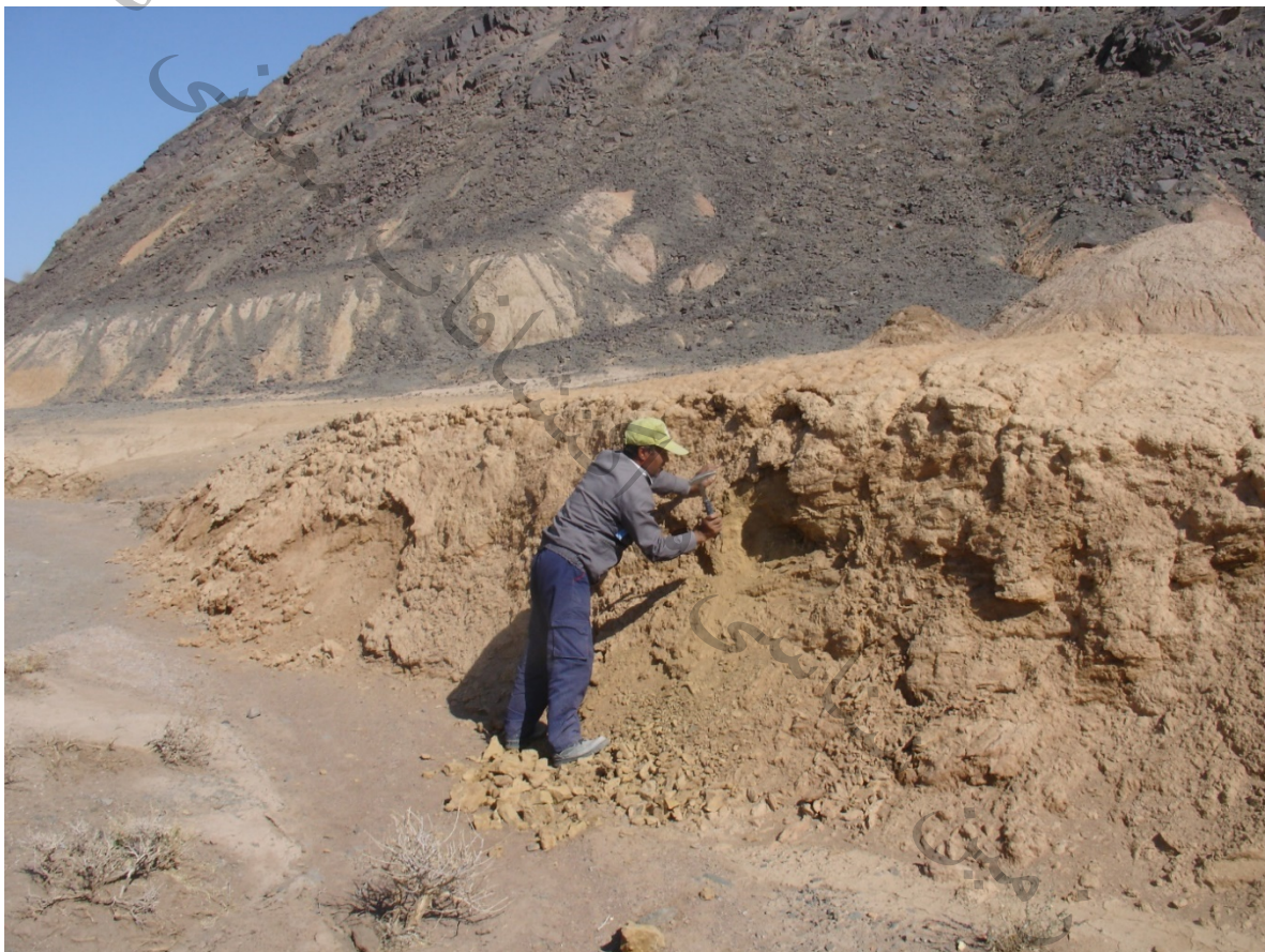
شکل ۳-۶۸- واحد سنگی آلتره لیمونیتی- کائولینیتی ضعیف به رنگ زرد تا روشن رنگ جهت بررسی خاک صنعتی (دید به سوی جنوب شرق)
