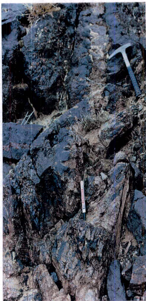
تصویر شماره ۳۷- رگه آپاتیت در داخل سنگ سبز که شامل آپاتیت و آهن است.
