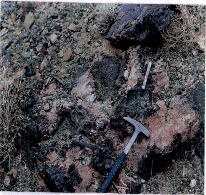
تصویر شماره ۵۰- رگه آپاتیت به همراه آهن و کلسیت دیده می شود. آپاتیت بلورهای کلسیت را دربر گرفته است.
