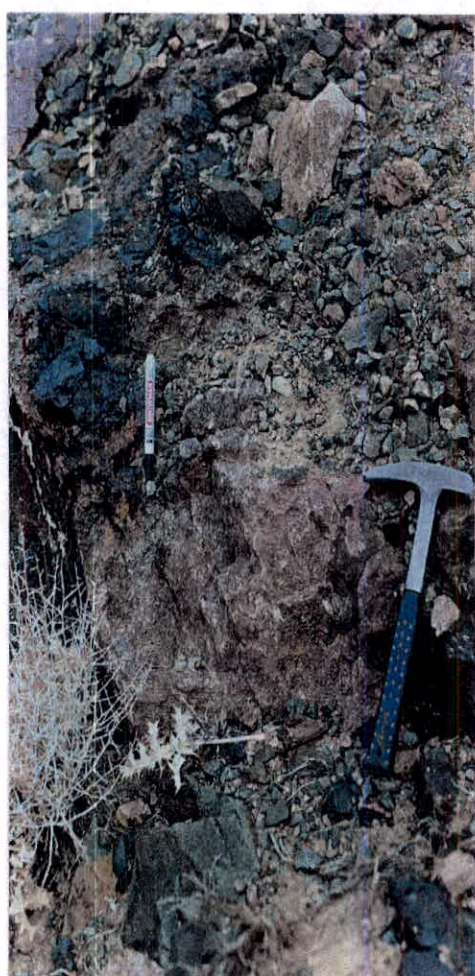
تصویر شماره ۴۳- نمایی از رگه‌های آپاتیتی ضخیم در داخل سنگ سبز
