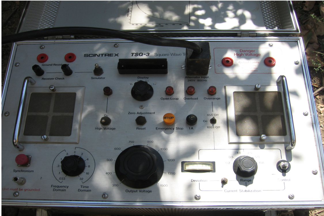
شکل ب - دستگاه ترانسیمتر TSQ-3
