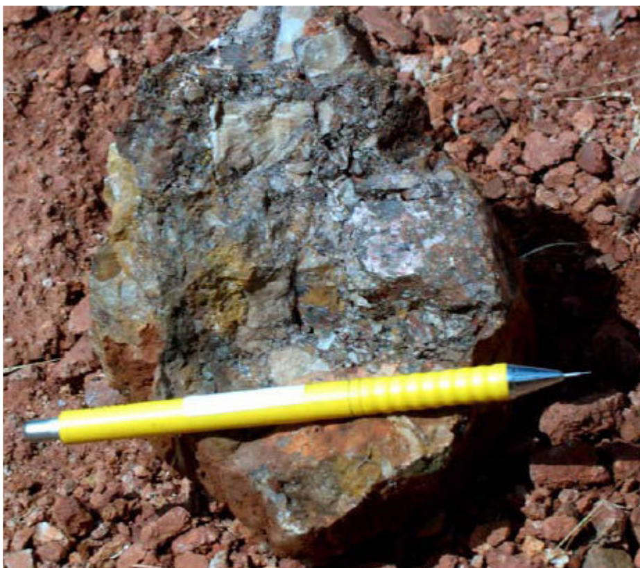
تصویر ۶-۵- نمونه‌ای از فلوت‌های حاوی اکسید آهن و کربنات مس
