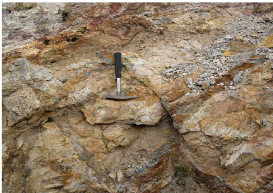
تصویر ۶-۲۶- نمائی از واحدهای ولکانیک دگرسان که توسط رگه‌های سیلیسی قطع شده است در منطقه روستای پهناور
