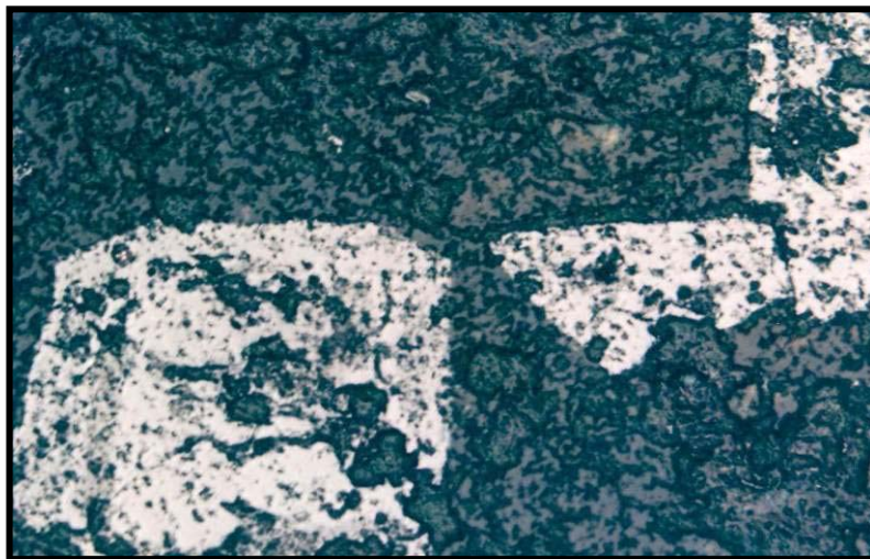
شکل ۴-۲۲- پیریت در حال تجزیه به گوتیت
