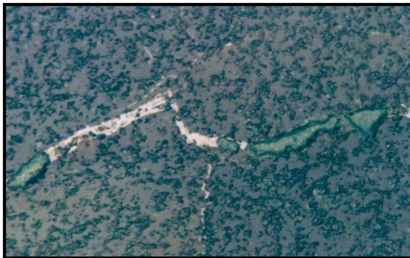
شکل ۴-۴۰- رگچه‌های ملاکیت و پیریت داخل گانگ کوارتز
