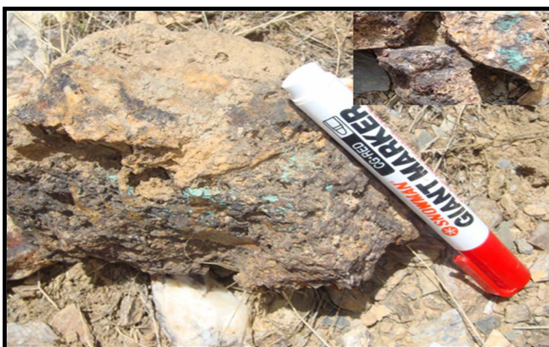
شکل ۴-۲- نمایی از کانه‌زایی آهن- مس ثانویه در لایه سیلیسی شمال روستای حلور بالا
