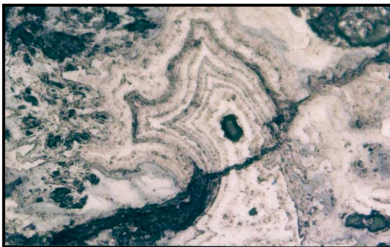
شکل ۳۴-۴- بافت زونینگ در پیریت
