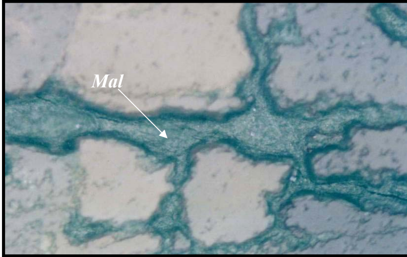
شکل ۴-۱۷- رگچه مالاکیت داخل گانگ کوارتز
