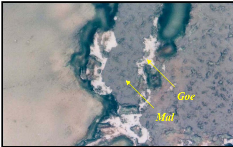
شکل ۴-۳۹- رگچه‌های گوتیت و ملاکیت داخل کوارتز
