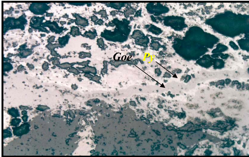
شکل ۴-۹- جانشین شدن پیریت Py توسط گوتیت Goe
