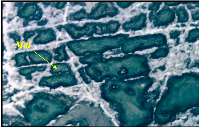
شکل ۴-۱۵- بافت جعبه ای گوتیت که حفرات آن توسط مالاکیت پر شده است
