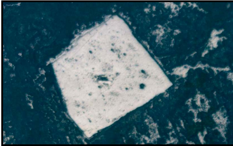
شکل ۴-۲۱- پیریت شکل دار داخل گانگ کوارتز
