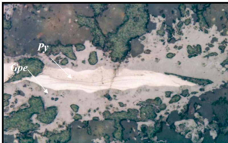
شکل ۴-۱۹- پیریت که از حواشی در حال تبدیل به گوتیت می باشد
