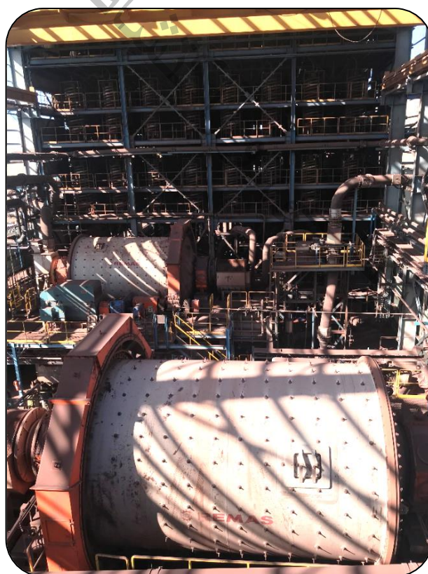
شکل (۲-۳): مدار خردایش و پرعیارسازی ثقلی معدن رضوان
