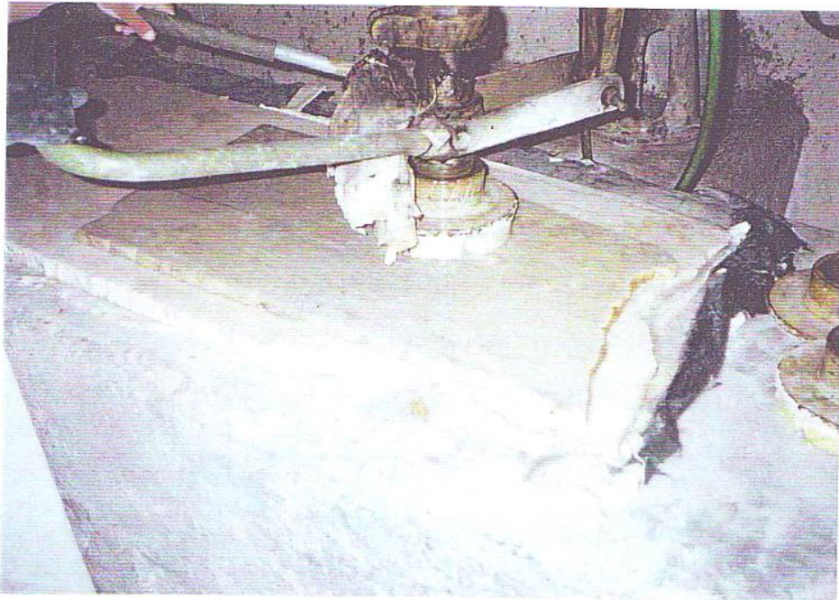
عکس شماره ۹۱- ساب و صیقل پلاک تهیه شده از محدوده پانزده گدومه
