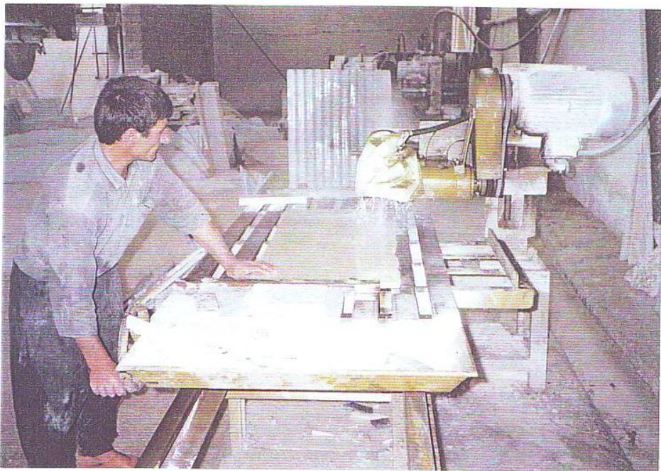
عکس شماره ۹۲- مرحله برش نهایی پلاک تهیه شده به ابعاد دلخواه
