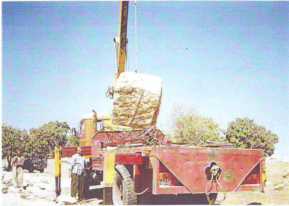
عکس شماره ۸۵- بارگیری بلوک سنگی اخذ شده در محدوده یک گدمه
