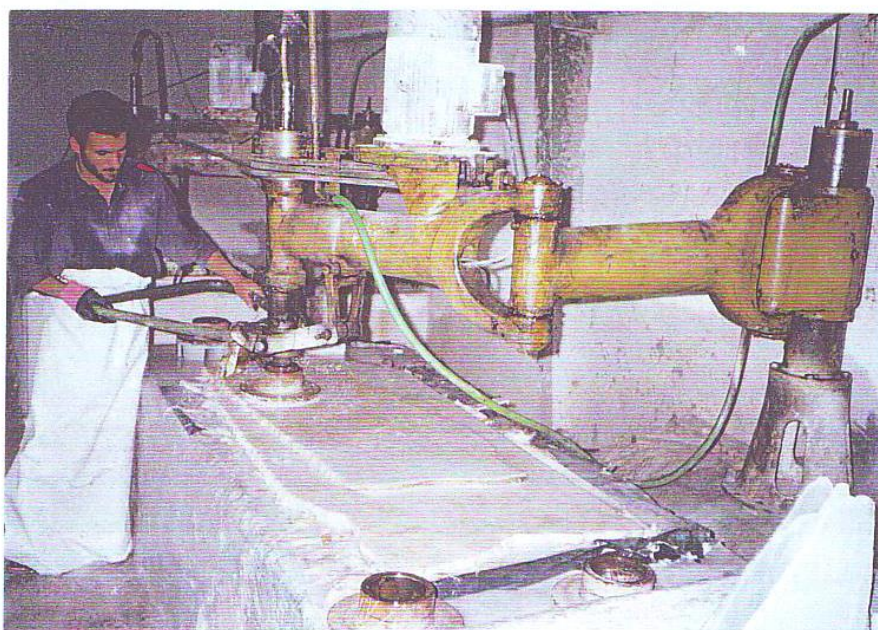
عکس شماره ۹۰- ساب و صیقل پلاک تهیه شده از محدوده یک گدمه
