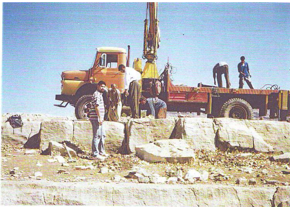
عکس شماره ۸۳- جدا کردن بلوک سنگ با استفاده از دیلم و گوه از طریق باز کردن درز و شکافهای طبیعی
