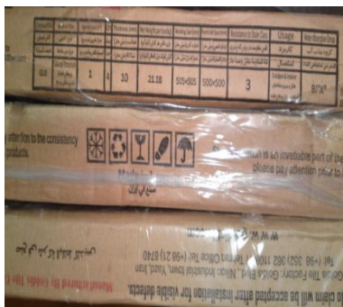
شکل ۲-۵-۱- مشخصات کاشی مندرج بر روی کارتن‌های بسته‌بندی
