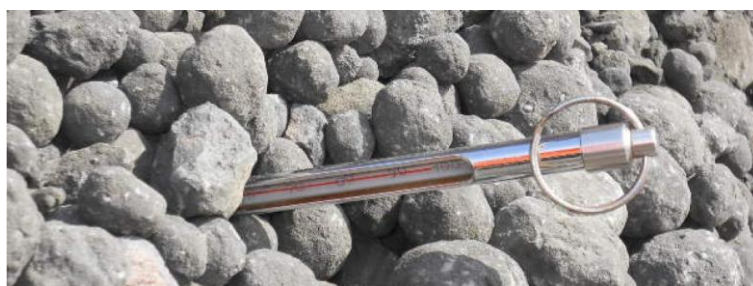
شکل ۲-۱۱-۲ کلینکر سیمان، از پختن ترکیبات سیمان در دمای ۱۴۰۰ درجه حاصل می شود
