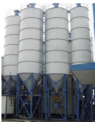
شکل ۲-۱۱-۷ انبار کردن سیمان در سیلوها با ابعاد و اندازه‌های مختلف بر حسب نوع و مشخصات استفاده
