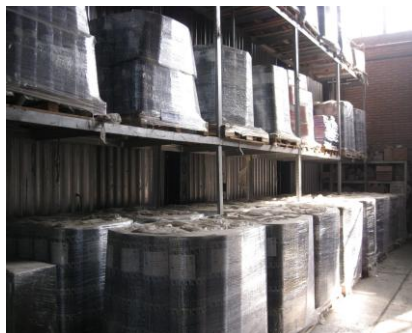
شکل ۲-۳-۳- انبارش عایق‌های رطوبتی با پوشش پلی‌اتیلن و برچسب در قفسه‌ها
