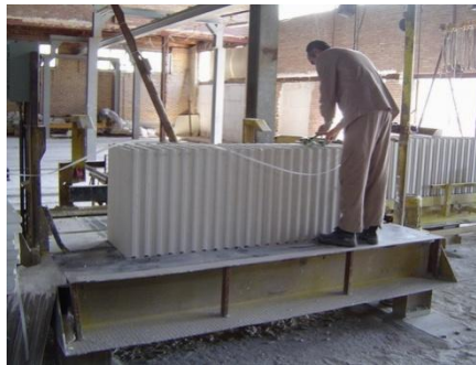
شکل ۲-۷-۲ بسته بندی بلوک های گچی روی پالت
