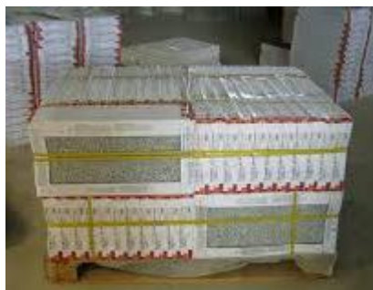
شکل ۲-۵-۴- چیدمان عمودی و آجری کارتن‌ها بر روی پالت
