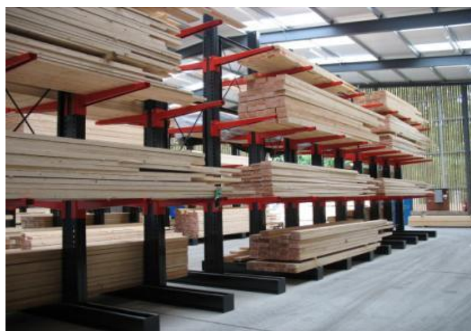
شکل ۲-۲۷-۱۷- انبار مناسب چوب در کارخانه
