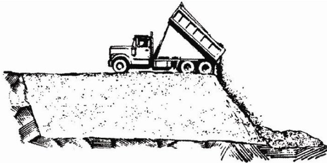
شکل ۲-۱۲-۳ از روش های تخلیه بار که شامل ریختن سنگدانه ها از بالاست باید اجتناب شود.
