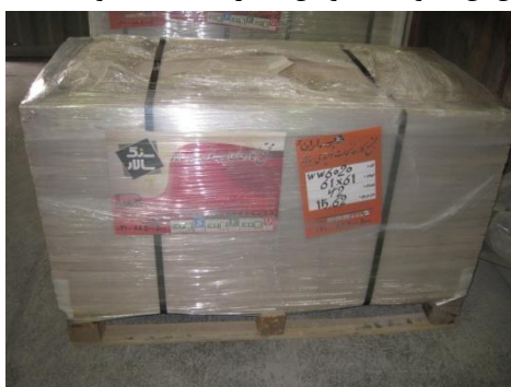
شکل ۲-۲۱-۵- نمونه‌ای از بسته بندی نهایی موزاییک در کارخانه
