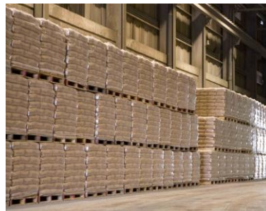
شکل ۲-۱۱-۴ نگهداری سیمان به صورت کیسه‌ای، یکی از روش‌های متداول حمل و نگهداری سیمان
