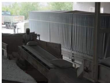
شکل ۱-۱۰-۲ انتقال گچ های پاکتی از طریق تسمه نقاله به وسیله حمل‌کننده
