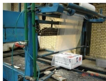
شکل ۲-۵-۲- دستگاه شرینگ کارتن‌های کاشی
