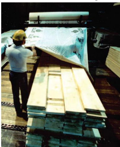
شکل ۲-۲۷-۱۳- پوشاندن الوارهای چوبی در کارخانه
