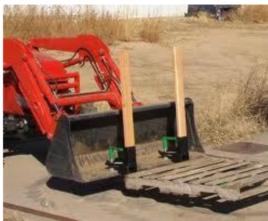
شکل ۱۴-۱-۲- ماشین حمل آجر با پالت و محافظ چوبی
