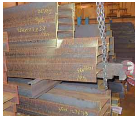
شکل ۲-۱۴-۴- نمونه ای از وسایل مناسب برای بارگیری و باراندازی تیرآهن
