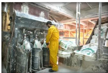
شکل ۲-۱۰-۲ بسته‌بندی گچ ساختمانی و اندوذهای گچی آماده پس از تولید
