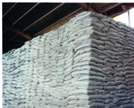
شکل ۲-۱۰-۴ نگهداری گچ‌های پاکتی در فضای سرپوشیده
