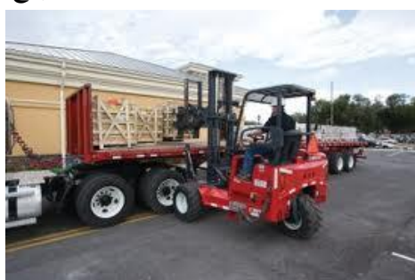
شکل ۲-۵-۷- انتقال پالت به وسیله نقلیه توسط لیفتراک و چرخ دستی
