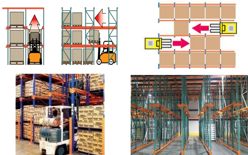
شکل ۴-۱ - قفسه راندن به داخل/میان (Drive in \ thru rack)
