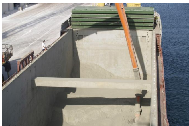
شکل ۲-۱۱-۱۶ در حمل دریایی سیمان به صورت فله، محموله سیمان به شدت در معرض آسیب است.
