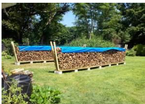
شکل ۲-۲۷-۱۸-نگهداری الوار چوب در فضای باز با پوششی بر روی آن‌ها
