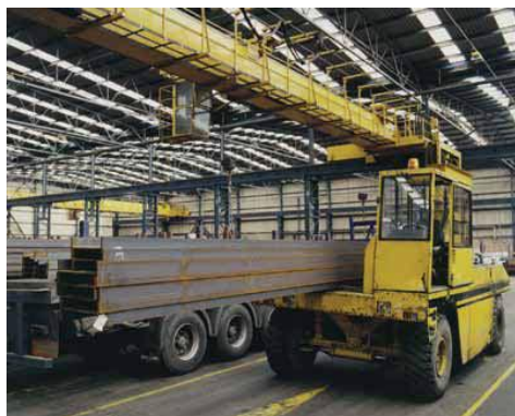
شکل ۲-۱۴-۴- نمونه ای از وسایل مناسب برای بارگیری و باراندازی تیرآهن
