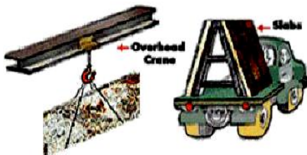
شکل ۲-۱۳-۱۲- کامیون مجهز به قاب A و جابجایی سنگ با جرثقیل حداقل شرایط کامیون دارا بودن سطح مسطح و وجود جرثقیل است. هنگام بارگیری و تخلیه بار باید از یک برنامه و هماهنگی قبلی استفاده شود. این برنامه‌ریزی موجب شناسایی خطرات و یافتن شیوه کار
