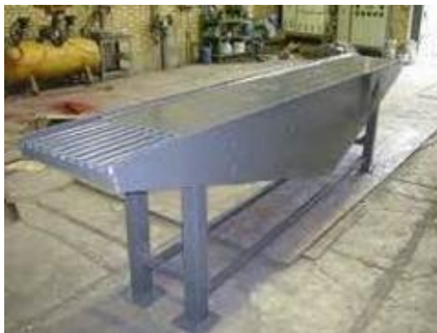
شکل ۲-۲۱-۱- دستگاه ویبره برای ساخت موزاییک
