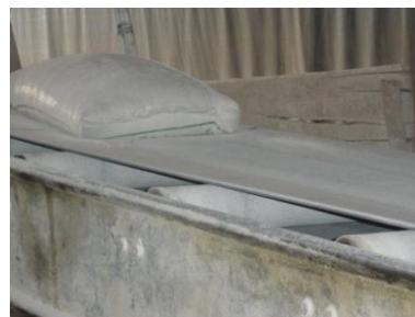
شکل ۱-۱۰-۲ انتقال گچ های پاکتی از طریق تسمه نقاله به وسیله حمل‌کننده
