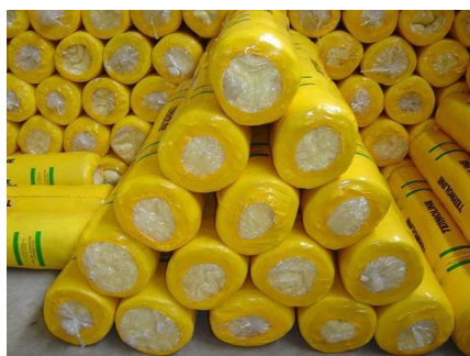
شکل ۲-۴-۱- قرارگیری عایق‌های پتویی (رولی) پشم معدنی
