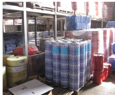
شکل ۲-۳-۲- انبارش عایق‌های رطوبتی با پوشش پلی‌اتیلن و برچسب در کف انبار
