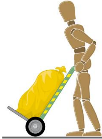
شکل ۱-۲۰- ارتفاع مناسب چرخ دستی حمل مصالح [۲۱]
