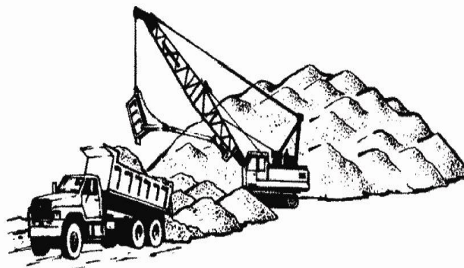
شکل ۲-۱۲-۴ روش تخلیه ترجیحی به منظور جلوگیری از جدایش
