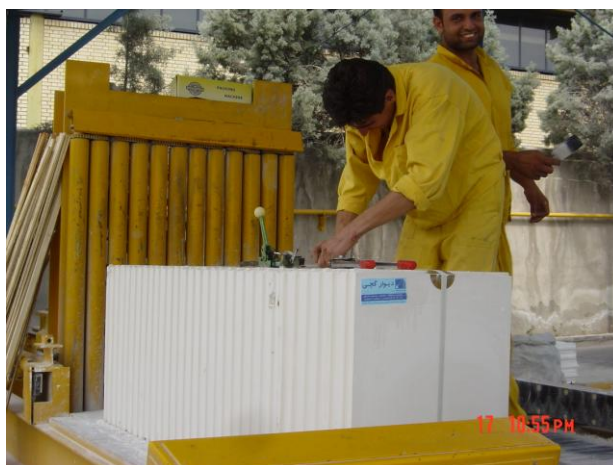
شکل ۲-۷-۳ برچسب‌گذاری و بسته‌بندی بلوک‌های گچی پس از خشک شدن
