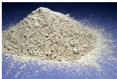
شکل ۱-۱۱-۲ سیمان از آسیاب کردن کلینر همراه با کمی سنگ گچ در کارخانه تولید سیمان حاصل می شود
