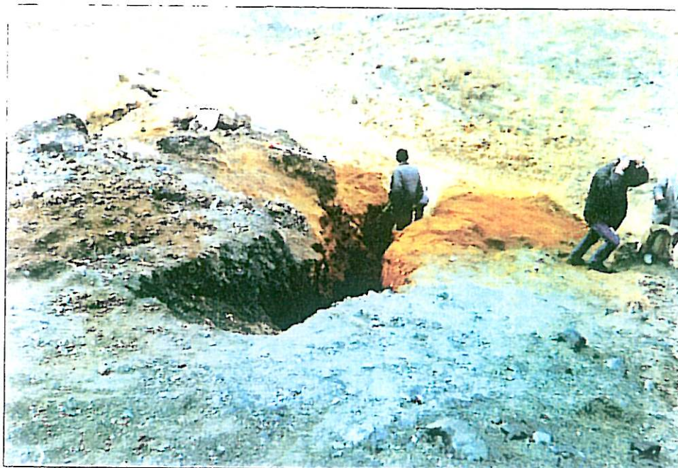
عکس شماره ۴-۷: دو نوع رخساره سنگی گوسن آهنی و آلونیت - کائولینیت در ترانشه حفرشده در جنوب زمین لغزه دیلک وردی آشکار گردیده است.
