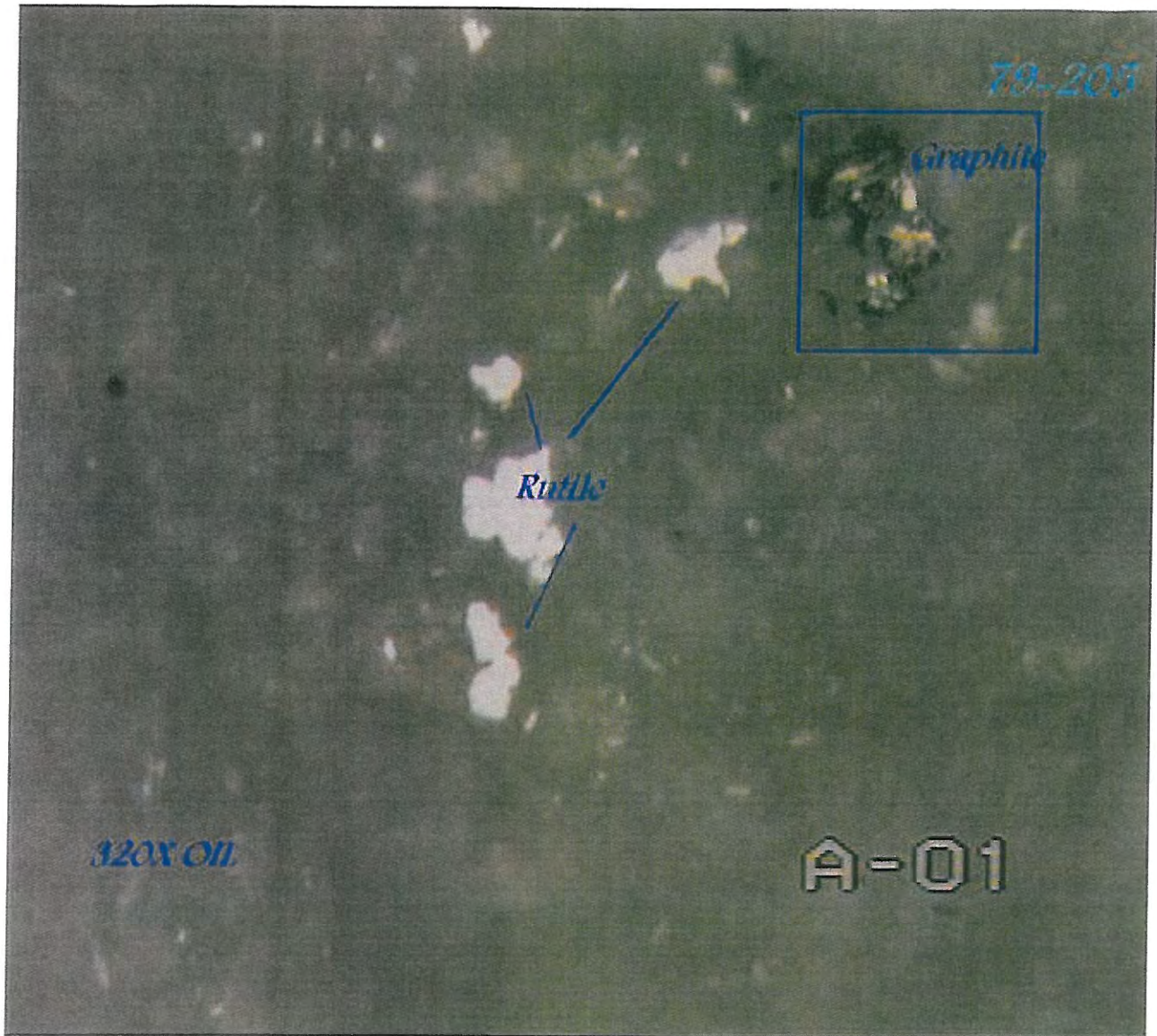
- بلور گرافیت و بلورهای روتیل را در نمونه UR-70 بوضوح مشاهده می‌نمائیم
