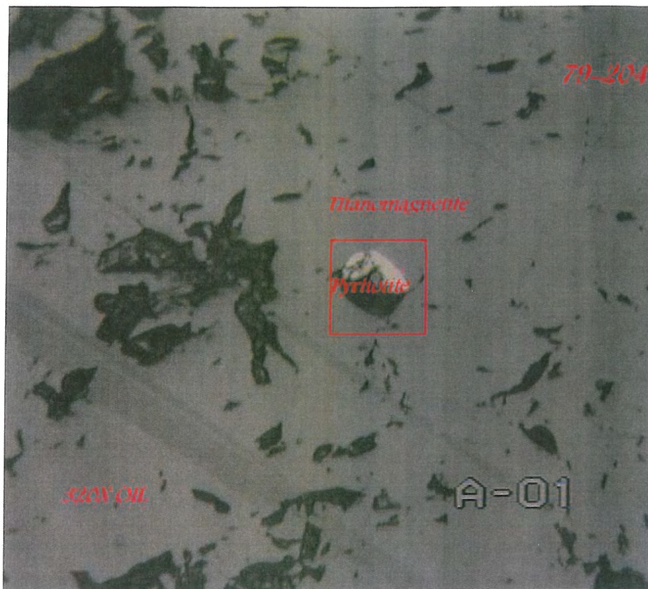
- متن زمینه مقطع صیقلی نمونه UR-108 از تیتانو منیتیت تشکیل شده است.
