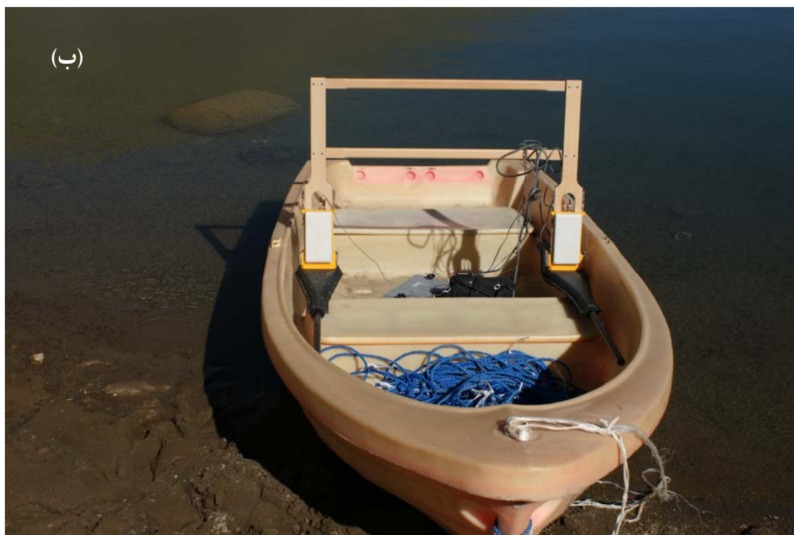
تصویر ۱-۲: نحوه برداشت داده ها با آنتن ۲۵ مگاهرتز به همراه پروفیل برداشت (الف)، آنتن ۵۰ مگاهرتز درون قایق (ب).
