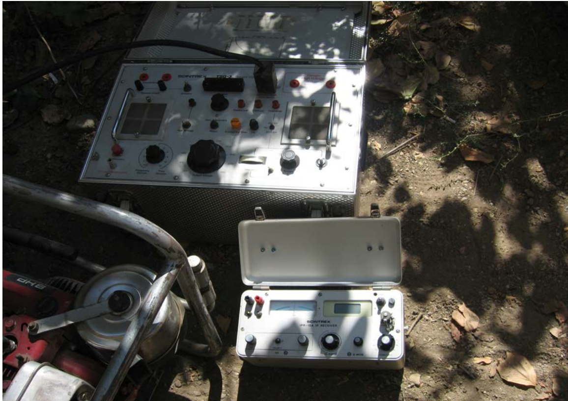
شکل الف - دستگاه ژنراتور ، دستگاه ترانسیمتر و دستگاه گیرنده
