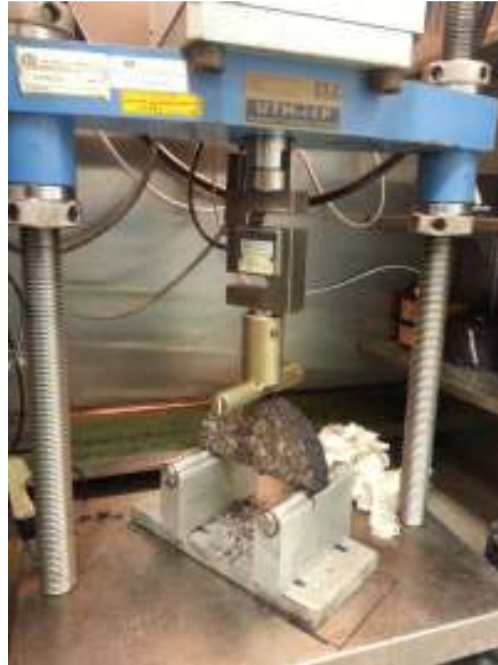
شکل ۲. نمایی از آزمایش تعیین نیروی شکست نمونه دیسکی شکل تحت خمش (SCB)
