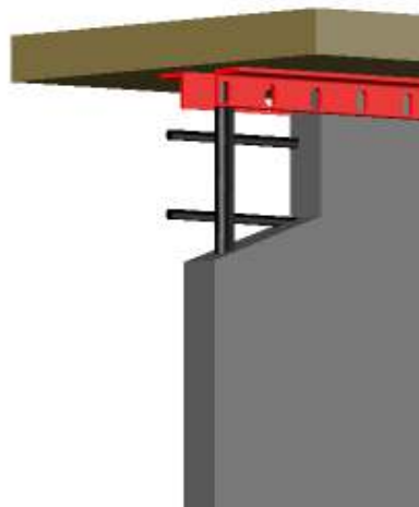
شکل ۵۹. اتصال دیوارها به سقف توسط پروفیل نبشی
