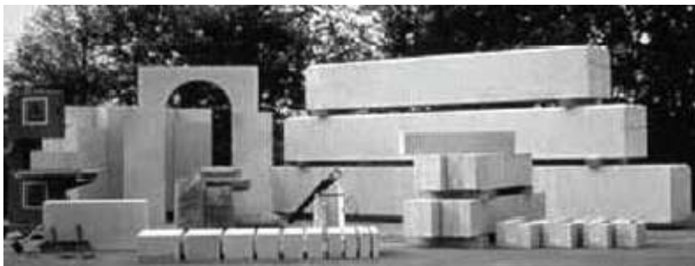
شکل ۵۴. قطعات مختلف ساخته شده از بتن سبک با کاربرد ساختمانی
