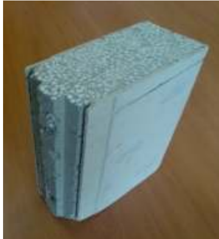
شکل ۲۰- پانل بتنی سبک با دانه‌های پلی‌استایرنی و روکش سیمان الیافی
