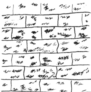
شکل (۵-۱۵): دیوار سنگی با رجهای مساوی
