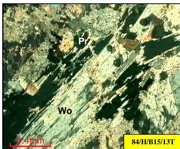
تصویر شماره ۱۶c : بلور ولاستونیت (Wo) در یکی از اسکارنها که از اطراف به پرهنیت (Pr) تبدیل شده است.
