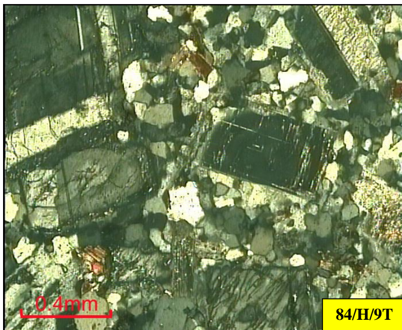
تصویر شماره ۷: نمائی از بافت پورفیری در گرانودیوریت پورفیری در نور XPL
