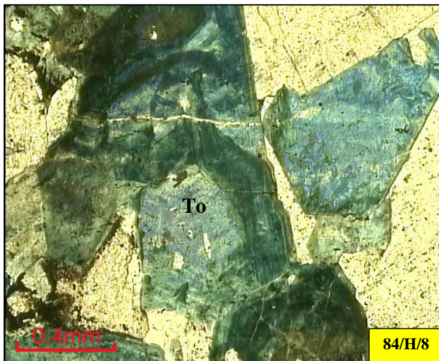
تصویر شماره ۴: ساختار زونی در تورمالین در یکی از تورمالینیتها در نور XPL To: تورمالین
