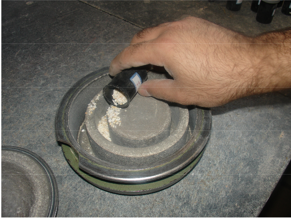
شکل ۳-۶- دستگاه پودرکن مورد استفاده جهت آماده‌سازی برای ارسال به آنالیز
