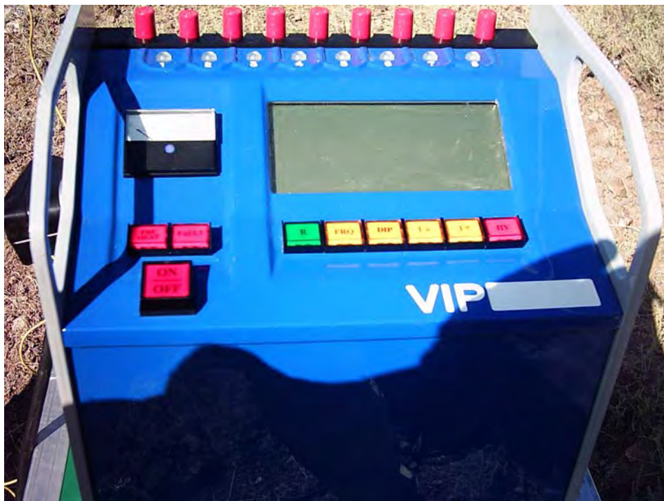
تصویر شماره ۷- ترانسمیتر VIP ساخت شرکت IRIS فرانسه
