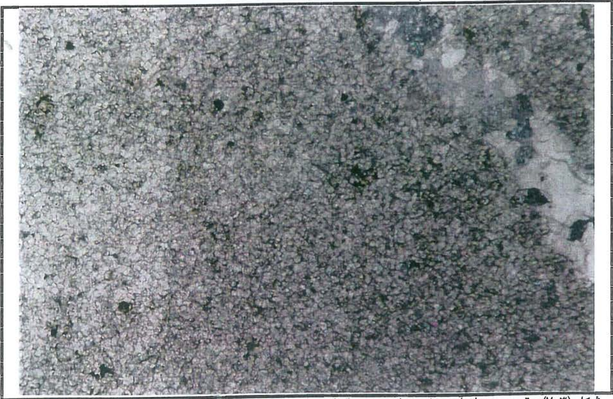
شکل (۳-۷) : تصویری از اهنکهای دولومیتی که بلورهای ریز نیمه‌خودشکل تا خودشکل دولومیت در متن سنگ قابل مشاهده است. علاوه بر این در گوشه سمت راست بالای تصویر یک رگه پر شده از کلسیت ثانویه مشاهده می‌گردد، (LP × 100).
